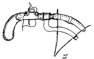
Figure 15-11. V-spring pistol eprouvette
