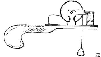
Figure 15-9. Gravity resistance eprouvette
