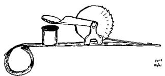
Figure 15-6. Simple straight eprouvette
