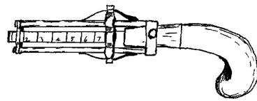
Figure 15-12. Friction bar pistol eprouvette
